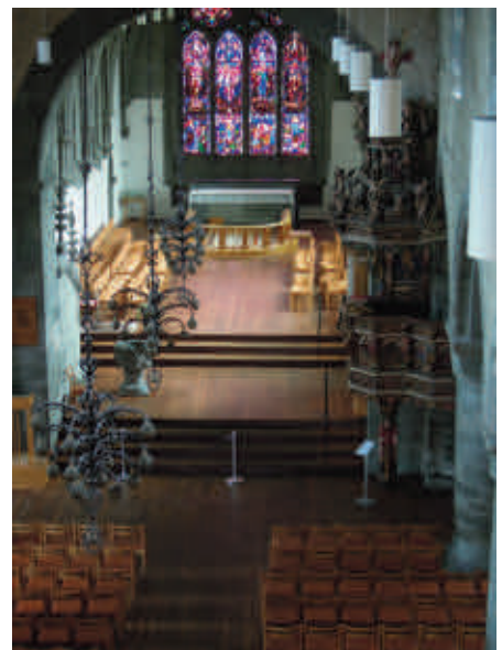
I belysningsplanen legges det opp til å beholde Emanuel Vigeland-armaturene. ERCO-bøttene fjernes. Ny belysning blir LED-basert med godt styringssystem (THX)
